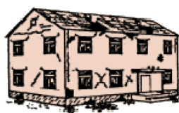
Figuur 8: Classificatie van schade voor metselwerk gebouwen volgens EMS-98. Illustratie afkomstig uit Ref. 6. Illustraties voor gradatie 4 en 5 zijn niet relevant voor dit document.
